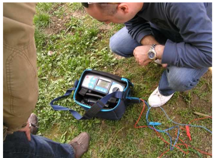
PROVERENA OTPORNOST UZEMLJIVAČA TO JE TO !!!
